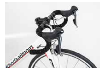
手が小さく力が弱い子どもでも、しっかり引けるサブブレーキレバー。
