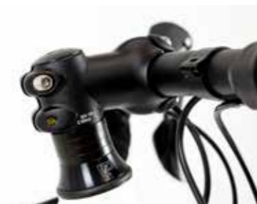
ステムは 60mm と 90mm の二本セットで、成長に合わせて交換できる。
